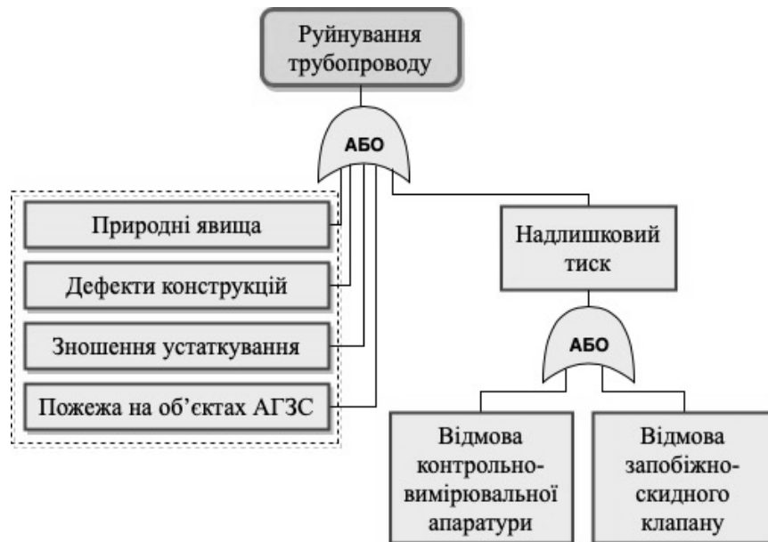
Рис. 2.3 Дерево відмов при руйнуванні трубопроводу
