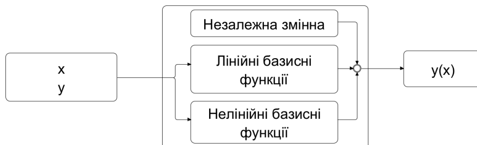
Рис. 2. Ідентифікація моделей статичних систем з нелінійними характеристиками
