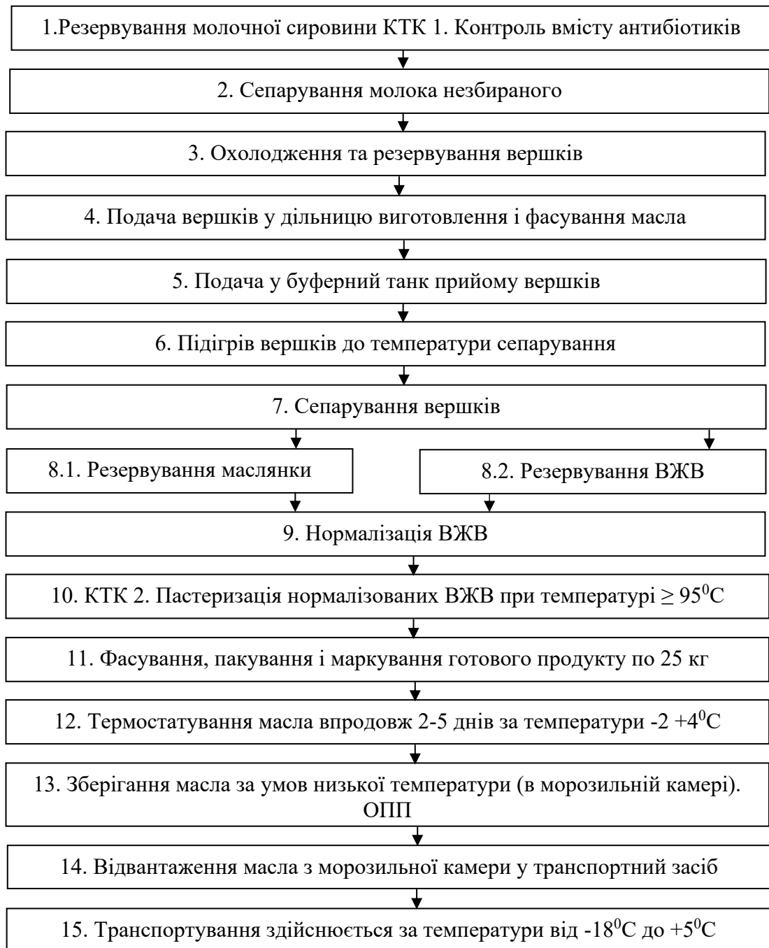
Рис. 5.1. Приклад блок-схеми виробництва масла солодковершкового
